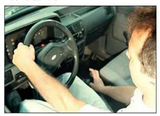
Dirigir com a mão pesando sobre a alavanca de marchas força o trambulador (peça fundamental na ligação entre o câmbio e as engrenagens da transmissão) e seus terminais, que podem desgastar-se excessivamente.
