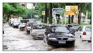
Passar por trechos alagados pode ser bastante oneroso para o proprietário do carro, caso o motor aspire água em vez de ar, provocando o calço hidráulico: como o pistão recebe água, que não se comprime, pode travar o motor e entortar as bielas, danificando-as seriamente. Evite passar por locais alagados quando a água ultrapassar a metade da roda.
