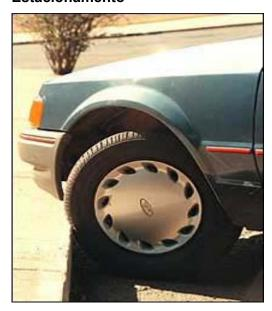
Apoiar o pneu no passeio (meio-fio) faz com que ele sofra a pressão do peso do veículo. Isso pode gerar uma deformação na estrutura, alterar a capacidade de resistência e uniformidade do pneu, além de afetar as condições de balanceamento do conjunto rodas/pneus.
