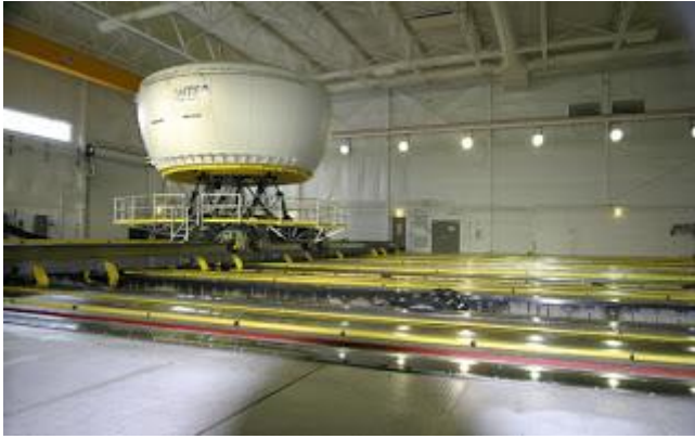
NADS-1. Simulador de alta fidelidade do National Advanced Driving Simulator Fonte: National Advanced Driving Simulator .
