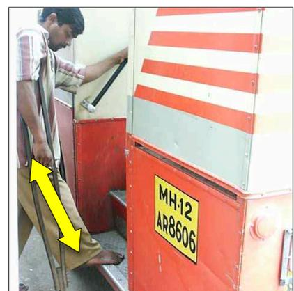
alimentadores con la característica de arrodillamiento para reducir la altura del autobús en varios centímetros, cuando sea necesario. (Foto cortesía de TRL, Ltd.)
