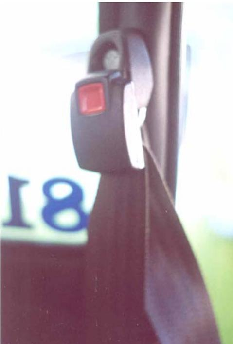
Figura 4-22 Fivela do cinto diagonal fixo encaixada na lingüeta de suporte junto ao terceiro ponto de ancoragem em um VW 81.
