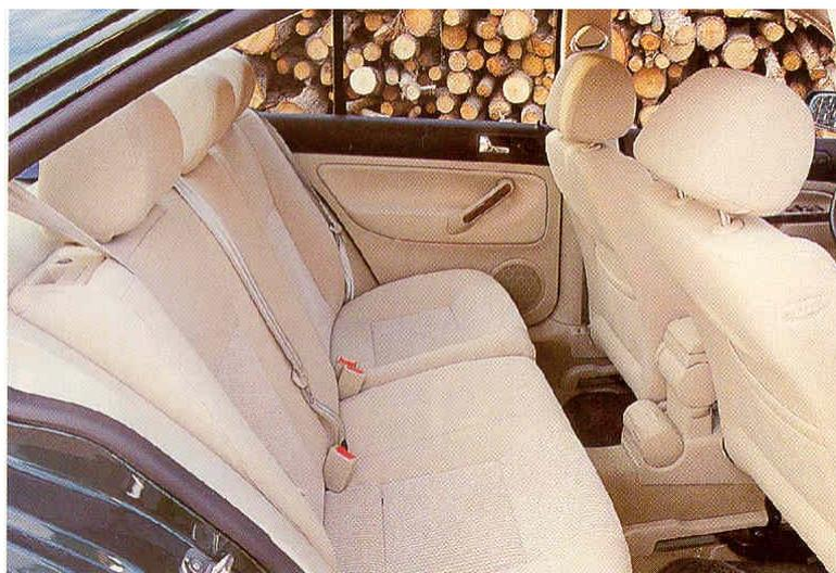
Figura 5-73 Disposição e visibilidade dos cintos do VW Bora.
