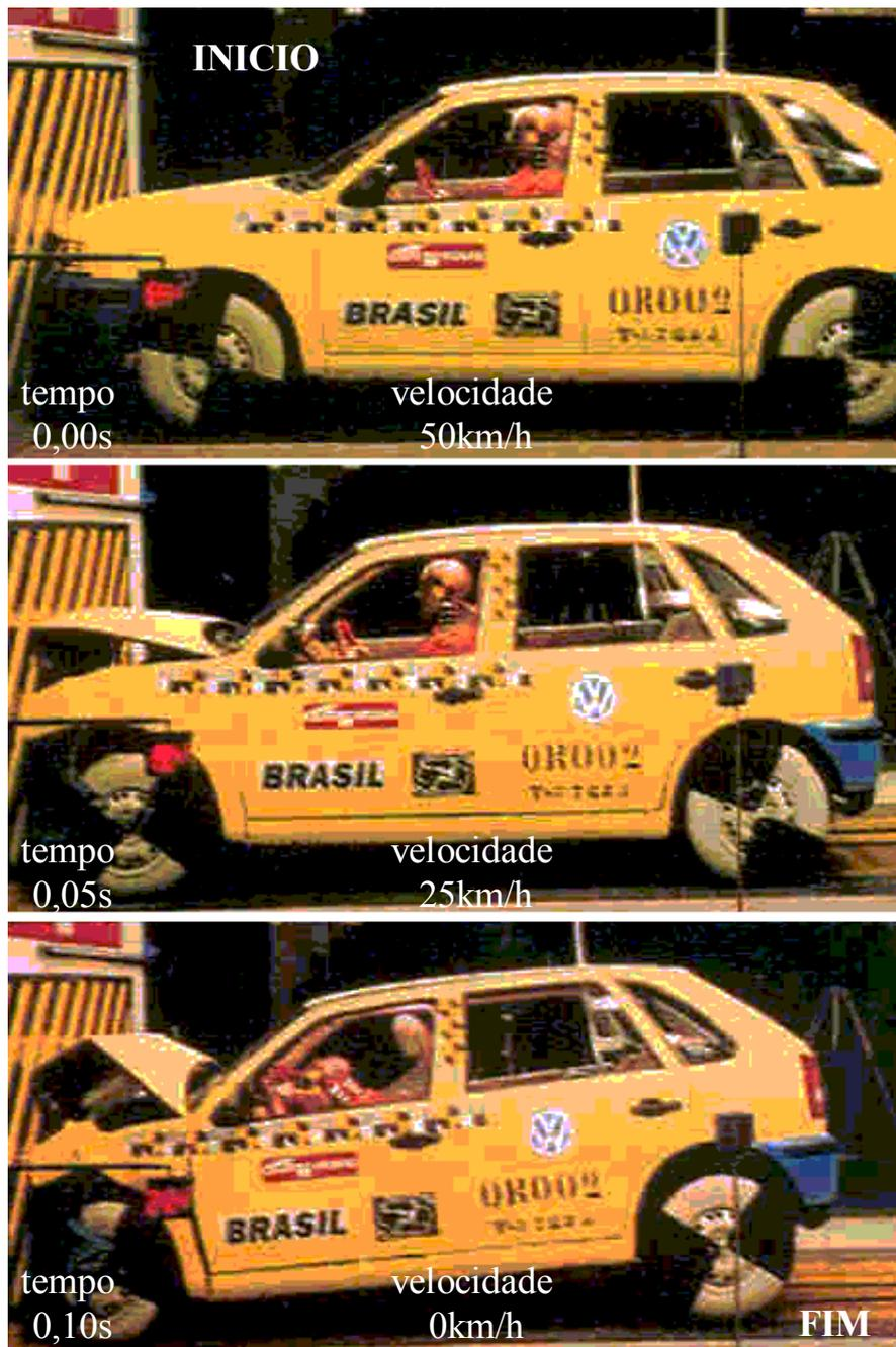
Figura 2-2 Montagem da seqüência de fotos do teste do Gol GIII (Quatro Rodas, nov. 2000)
