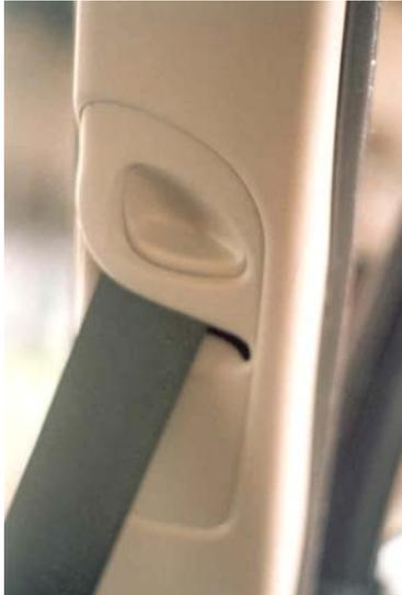
Figura 5-45 Dispositivo de regulagem de altura do Vectra.
