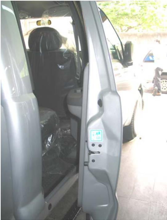
Figura 10-53 F-250 cabine dupla. Largura interna 1720mm, externa 2031mm. Espessura da porta 155,5mm. Portas largas são mais seguras em impactos laterais.
