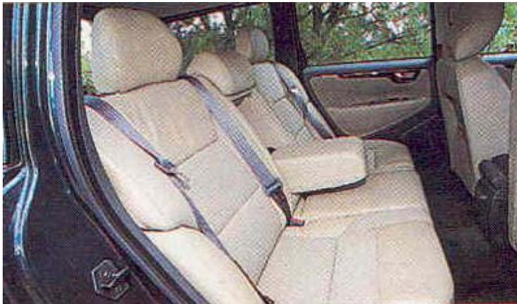
Figura 5-72 Disposição e visibilidade dos cintos do Volvo V70.
