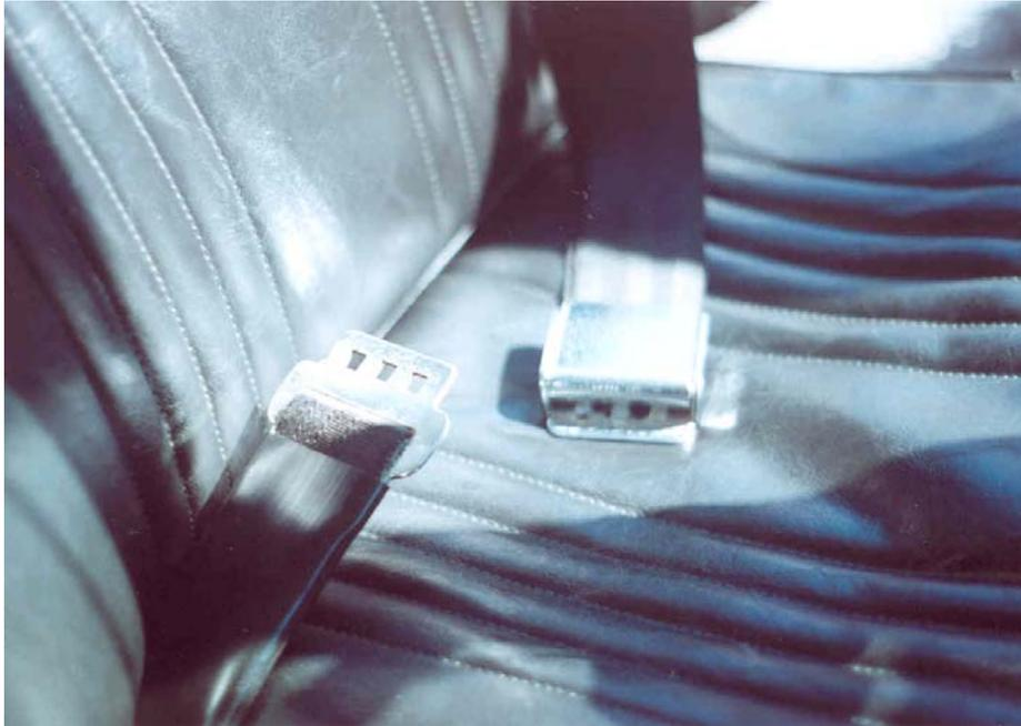
Figura 4-2 Fecho aberto tipo alavanca, com lingüeta na parte sem regulagem (E) e fivela na parte regulável do cinto (D) dianteiro subabdominal de 2 pontos com trava de 3 dentes em um carro antigo do início dos anos 70.
