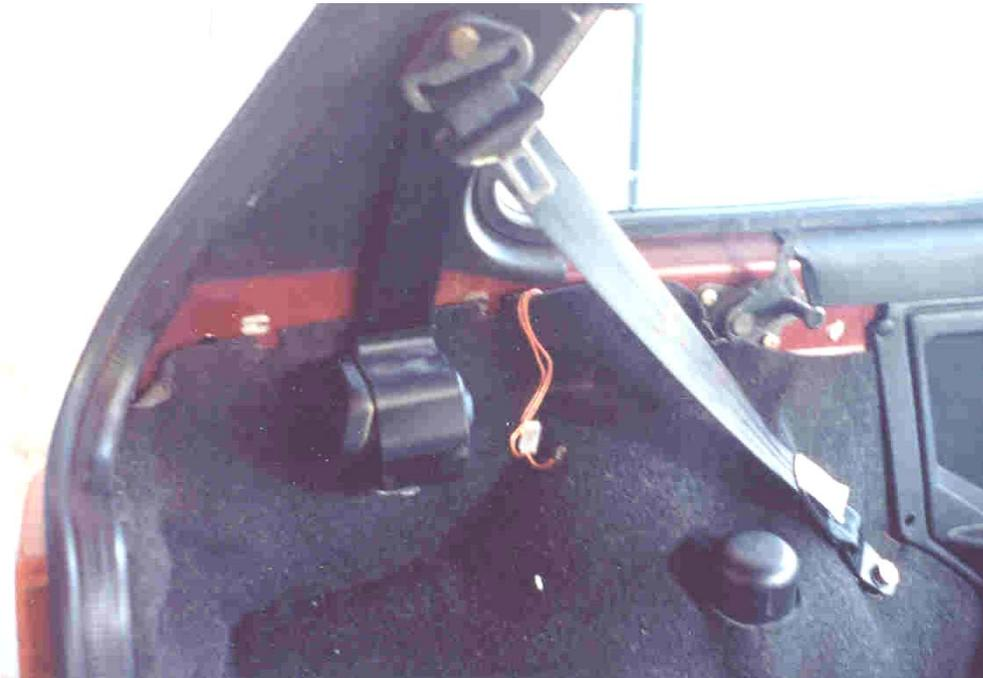
Figura 10-7 Foram fixadas as ancoragens do retrator e do 3° ponto com os seus respectivos parafusos de 17mm.
