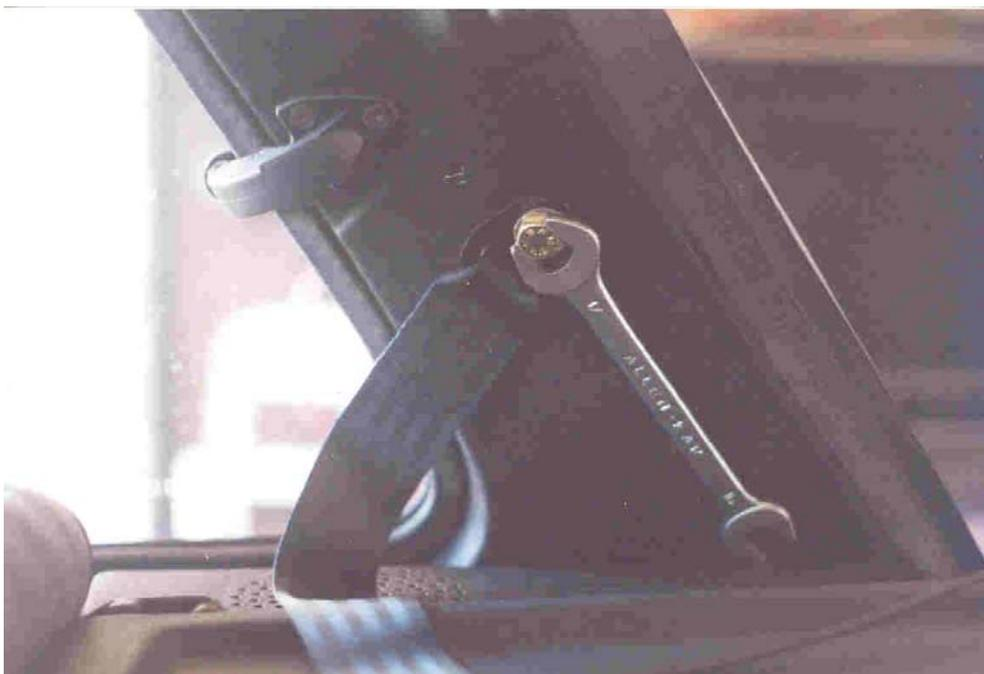
Figura 10-12 Detalhe do aperto do parafuso do 3º ponto com a chave fixa 17mm.
