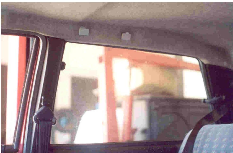
Figura 10-17 Detalhe das tampas do forro do teto lado esquerdo, depois da remoção.
