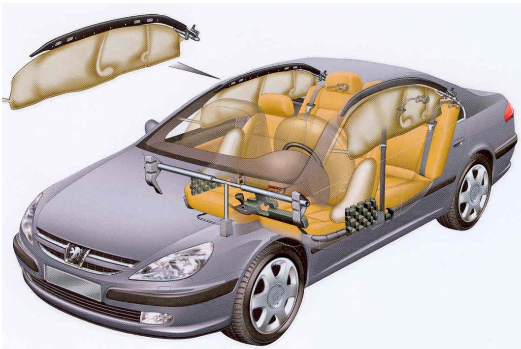
Figura 5-25 Peugeot 607. Divulgação da Peugeot. Todos os ‘Airbags’, destacando o window-bag.
