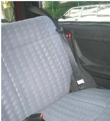
Figura 6-1 Cinto de 3 pontos retrátil.
