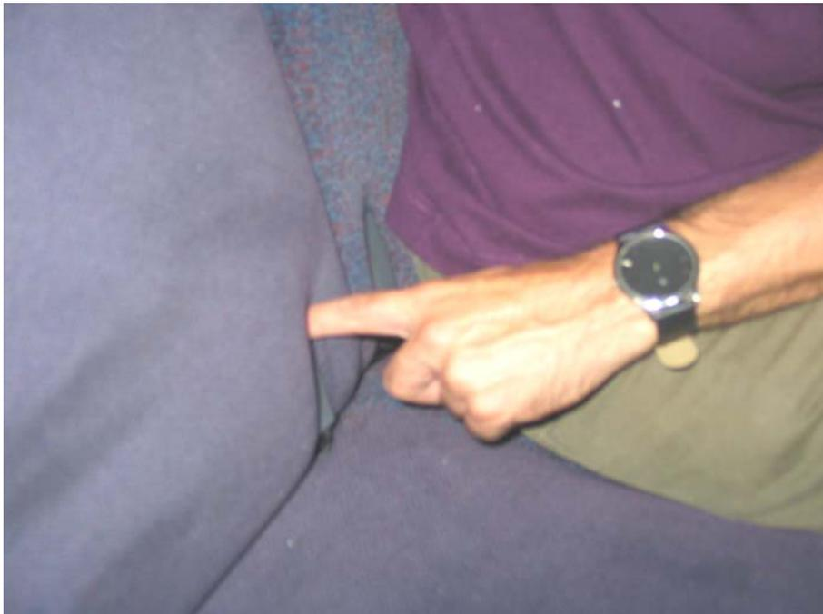
Figura 5-64 Tentativa 1: remover a fivela embutida no encosto do assento traseiro por cima (normal).
