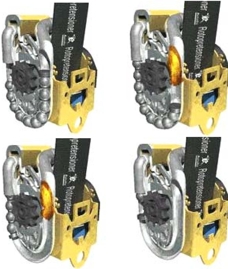
Figura 4-43 Pré-tensionador-retrator – Quadros retirados da animação Disponível em: <[http://www.autoliv.com/appl\\_alv/Autoliv.nsf/pages/seat\\_belts\\_pretensioners](http://www.autoliv.com/appl_alv/Autoliv.nsf/pages/seat_belts_pretensioners)> Acesso em: 20 jan. 2005.
