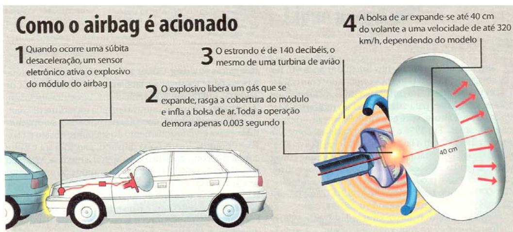
Figura 4-47 Funcionamento do 'Airbag'. Recorte Quatro Rodas, n. 480, jul. 2000, p.120.
