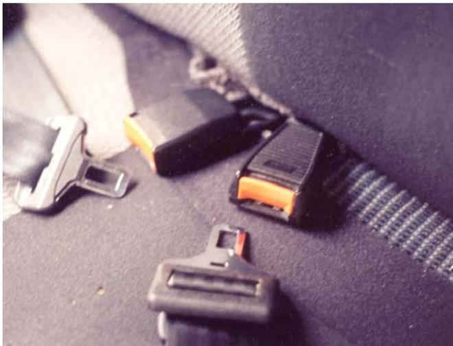
Figura 4-7 - Dois fechos abertos tipo ‘push-button’, com lingüetas nas partes reguláveis (E, baixo) e fivelas nas partes sem regulagem do cinto (D, alto), traseiros: o fecho mais acima é de 3 pontos retrátil original do Uno CSL argentino e o fecho mais abaixo é subabdominal de 2 pontos original do Mille EP 1996 brasileiro.
