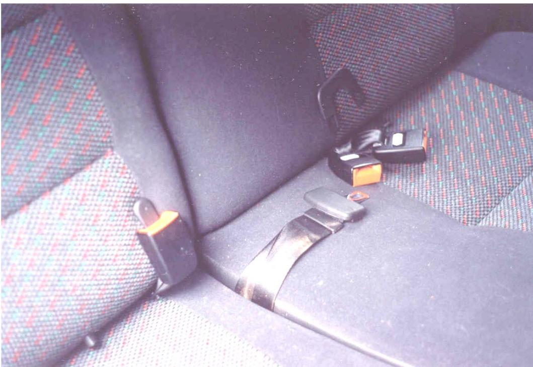
Figura 5-28 Encaixe para as fivelas dos cintos traseiro de um Peugeot 306 ano 1999.
