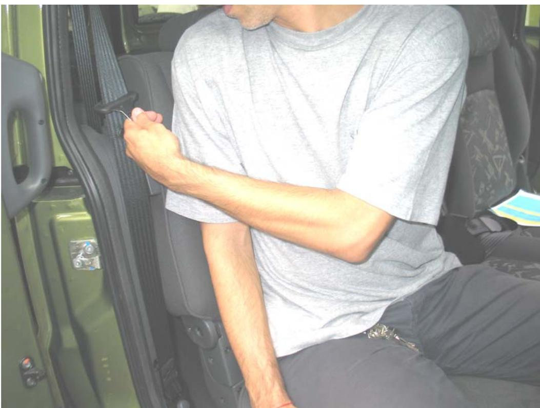
Figura 5-30 Torção excessiva do tronco para acessar a lingüeta do cinto traseiro em um Doblò ano 2004.
