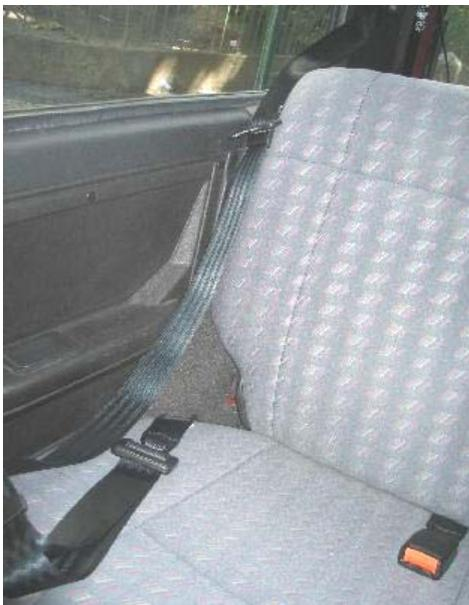
Figura 6-3 Cinto de 3 pontos fixo (estático)
