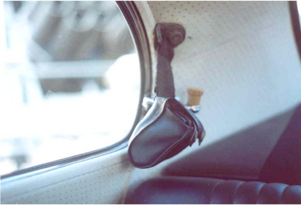
Figura 4-21 Cinto diagonal fixo enrolado dentro da bolsinha em um VW 72.
