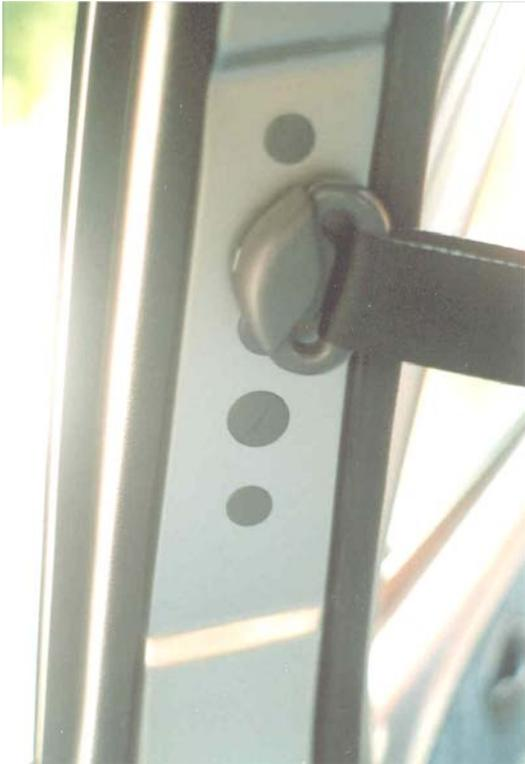
Figura 4-29 Ancoragem do cadorço do ombro no Palio possui mais dois pontos alternativos abaixo (os círculos menores nos extremos não são pontos de ancoragem).
