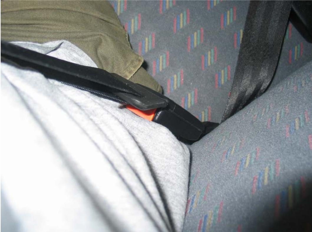
Figura 5-62 Fivela do Uno Mille colocada com o botão de destravamento para dentro.
