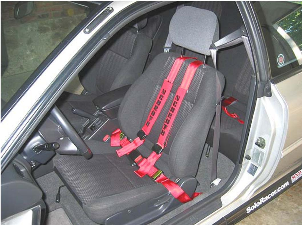
Figura 4-15 - Cinto de 4 pontos adaptado em um Subaru Impreza, ano 1998. Disponível em: <[http://store3.yimg.com//soloracerdotcom\\_1744\\_988275](http://store3.yimg.com//soloracerdotcom_1744_988275)> Acesso em: 4 jun. 2003.
