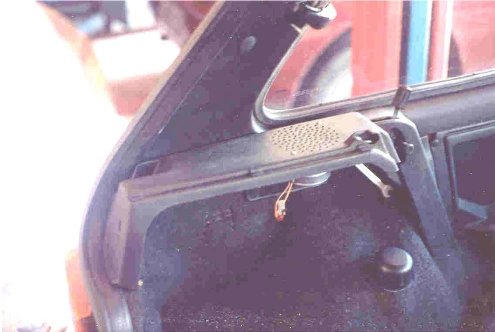
Figura 10-4a Com o encosto traseiro já basculado para frente, primeiro soltou-se a lateral do bagagito com chave fixa de 8mm. A foto mostra uma tampinha redonda na coluna 'C', no centro, no alto. Ela cobre o furo de acesso à ancoragem do 3 ponto de fixação do cinto, que foi utilizado nesta instalação. A foto mostra, também, uma janelinha picotada no carpete, logo abaixo da lateral do bagagito, do lado esquerdo dos terminais da fiação do alto-falante.
