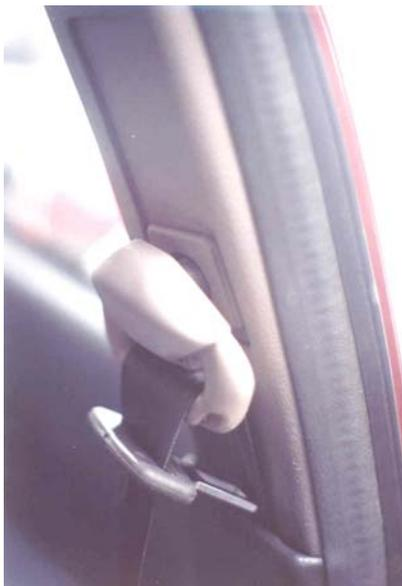
Figura 5-44 Dispositivo de regulagem de altura do Gol.
