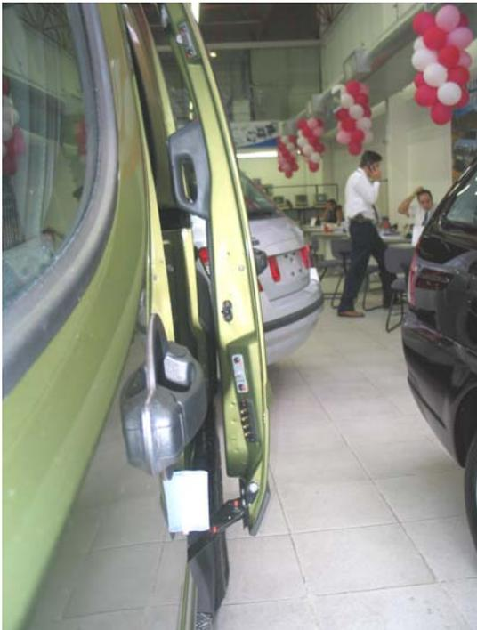
Figura 10-52 Doblô. Largura interna 1500mm, externa 1762mm. Espessura da porta 131mm. Portas estreitas são menos seguras em impactos laterais.
