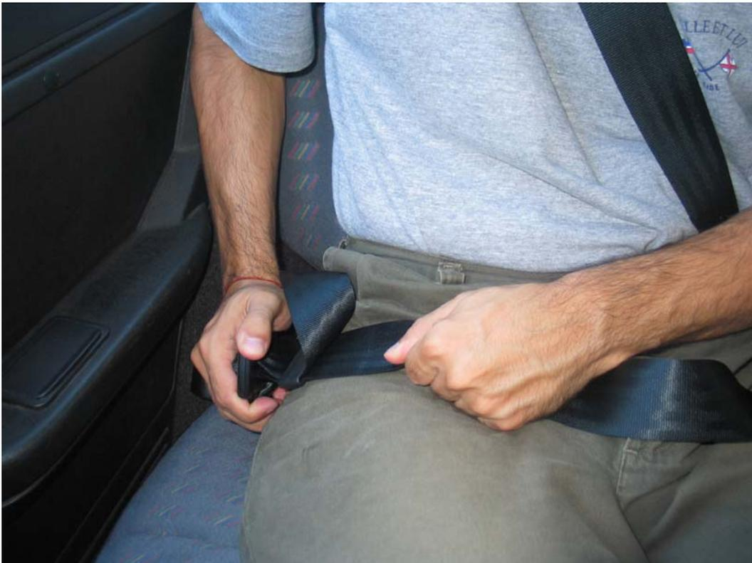
Figura 5-59 Cinto de 3 pontos fixo(sem retrator) original do Mille, do ano 1998 ao 2005.
