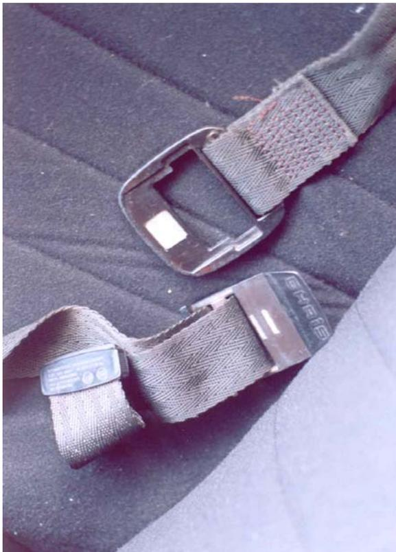
Figura 4-3 Fecho aberto tipo magnético, com lingüeta/alavanca na parte regulável (E) e fivela na parte sem regulagem do cinto (D) dianteiro subabdominal de 2 pontos de um Chevette 1973.
