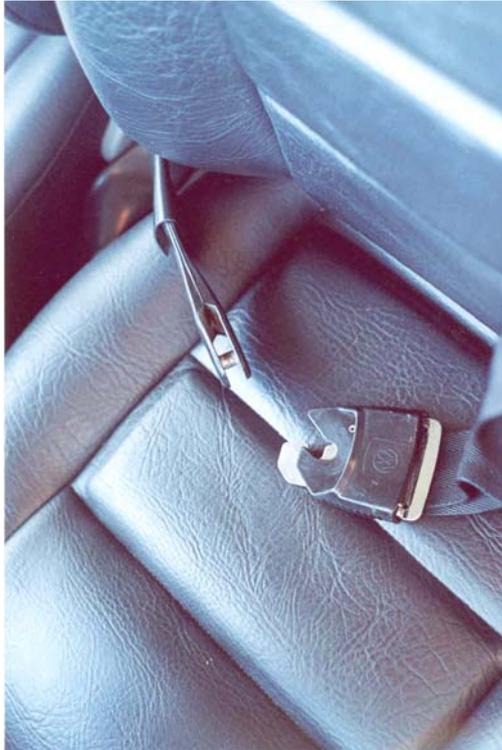
Figura 4-4 Fecho aberto tipo mosquetão, com pino macho na parte sem regulagem (E) e engate trava fêmea na parte regulável do cinto (D) dianteiro subabdominal de 2 pontos de um modelo VW dos anos 70.
