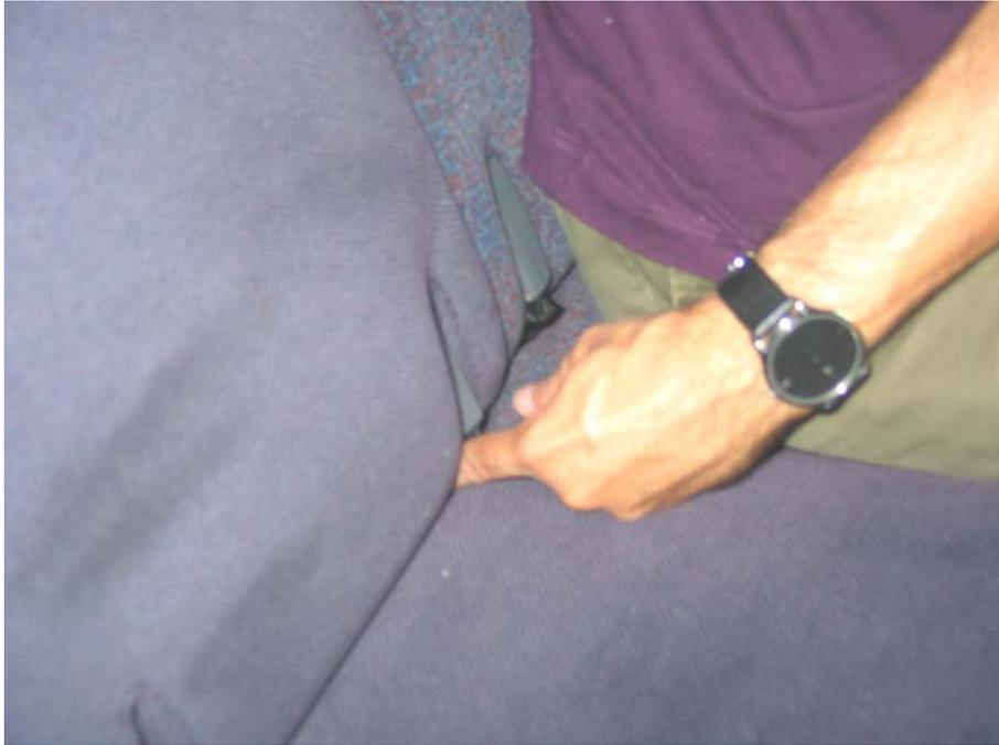
Figura 5-65 Tentativa 2: remover a fivela embutida no encosto do assento traseiro por baixo.
