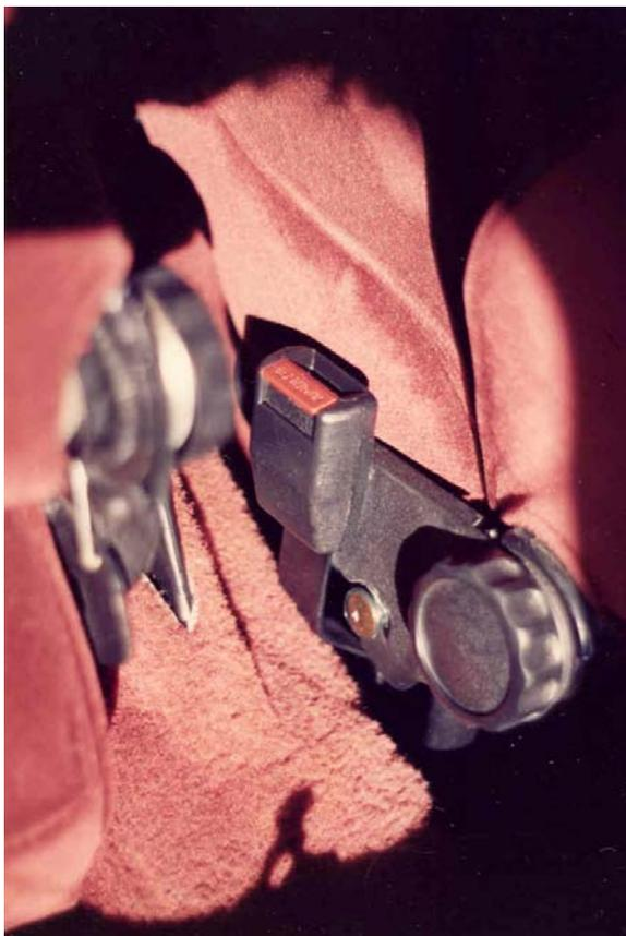
Figura 5-61 Haste da fivela do cinto dianteiro do Passat, ano 1986.
