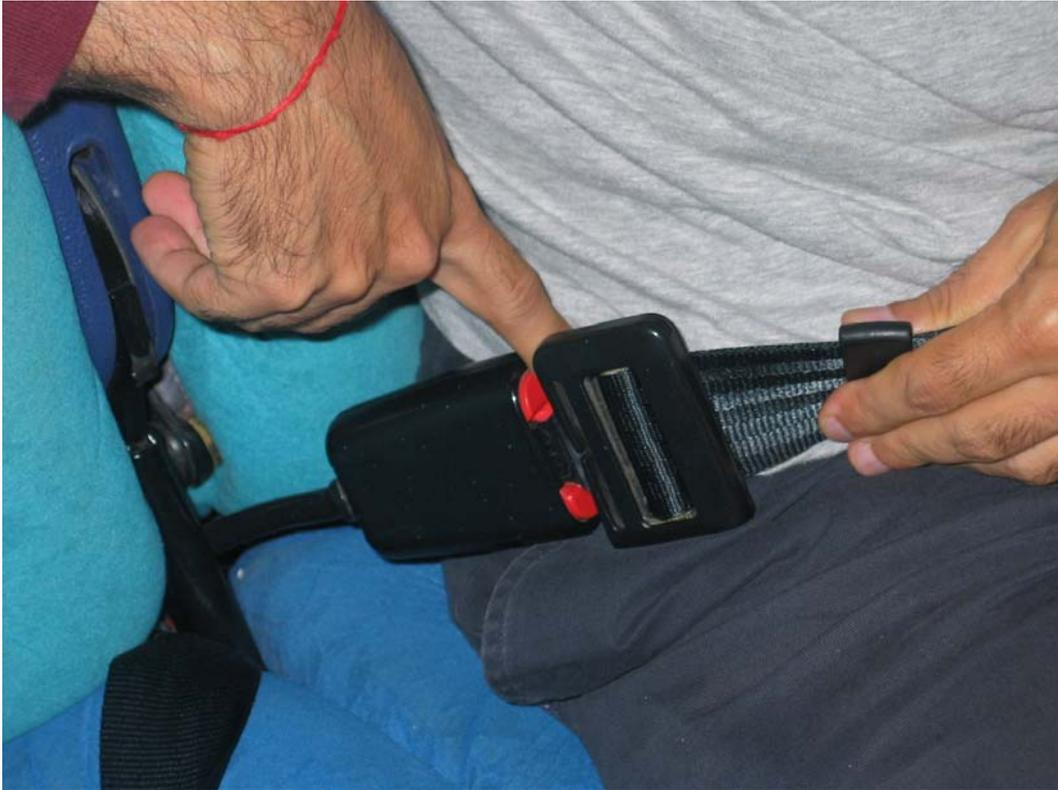
Figura 5-63 Dificuldade no destravamento em uma fivela com instalação invertida.
