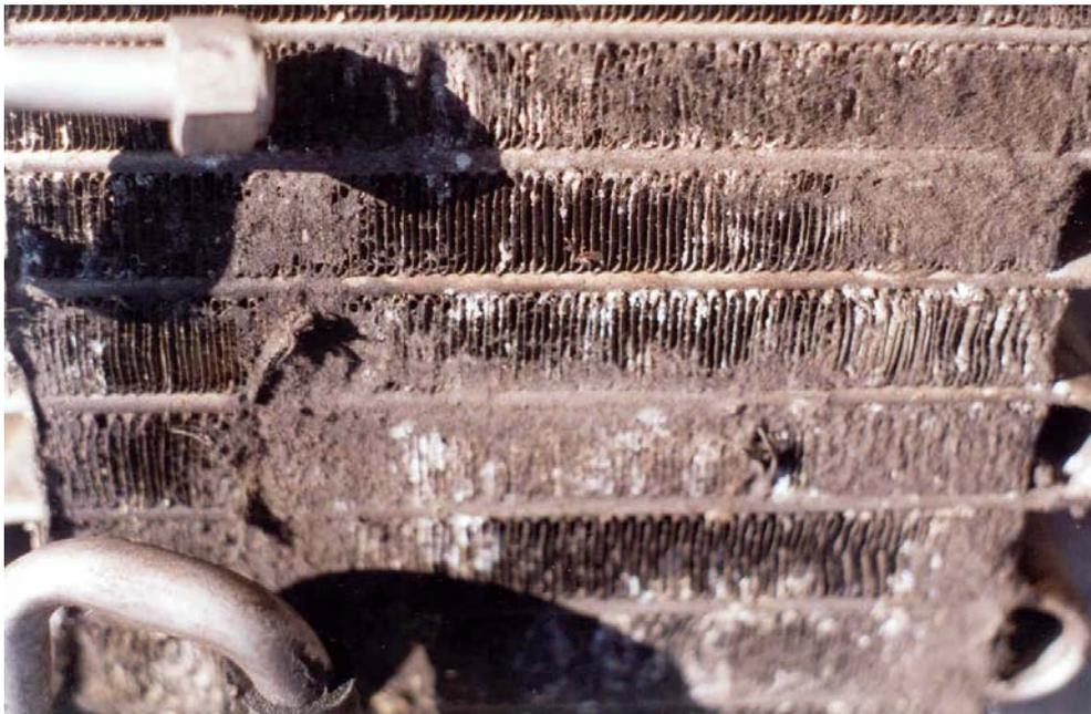
Figura 10-2 Contaminação existente no evaporador onde passa o ar ambiente para ser refrigerado.
