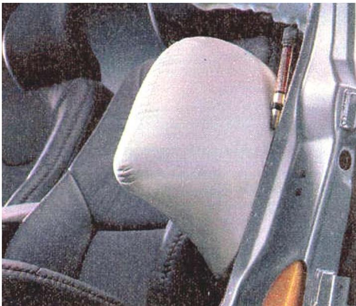
Figura 4-50 'Airbag' Lateral Volvo, Recorte da revista '40 anos de Quatro Rodas', n. 484-B, Segurança, p. 15.
