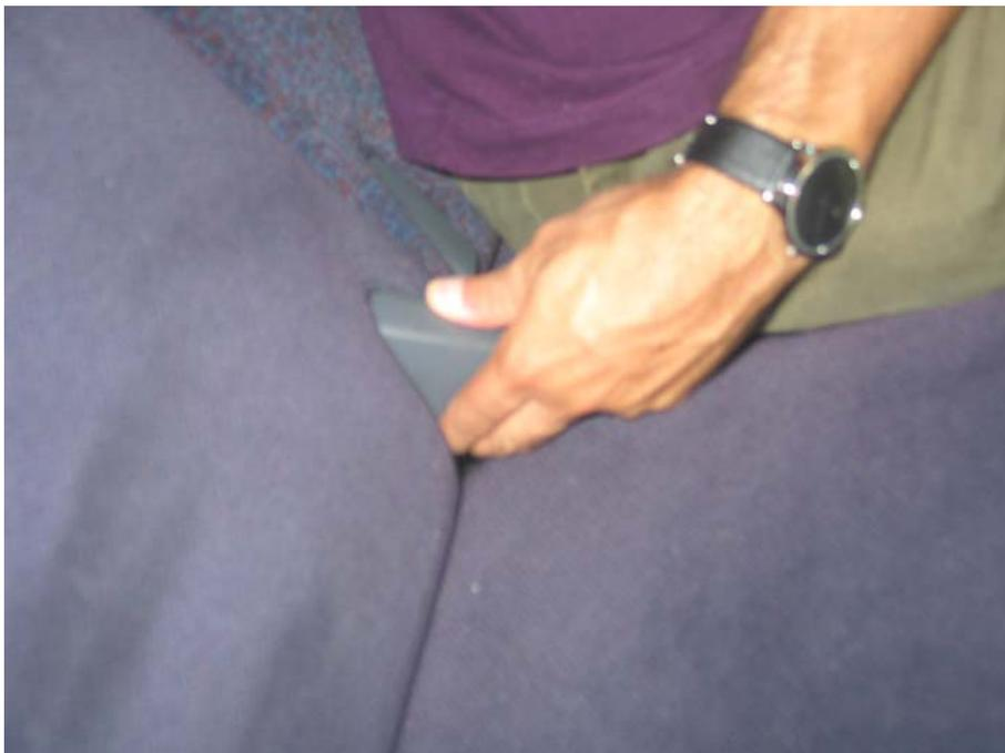
Figura 5-66 Tentativa 3: remover a fivela embutida no encosto do assento traseiro girando-a (final).
