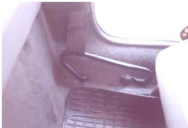
Figura 4-33 Trilho do Palio 2 portas visto de lado/dentro.
