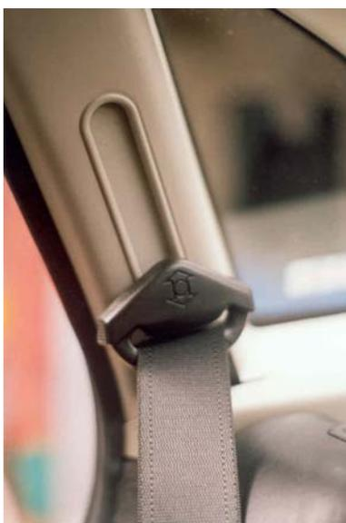
Figura 5-36 Regulagem altura cinto traseiro Vectra CD.
