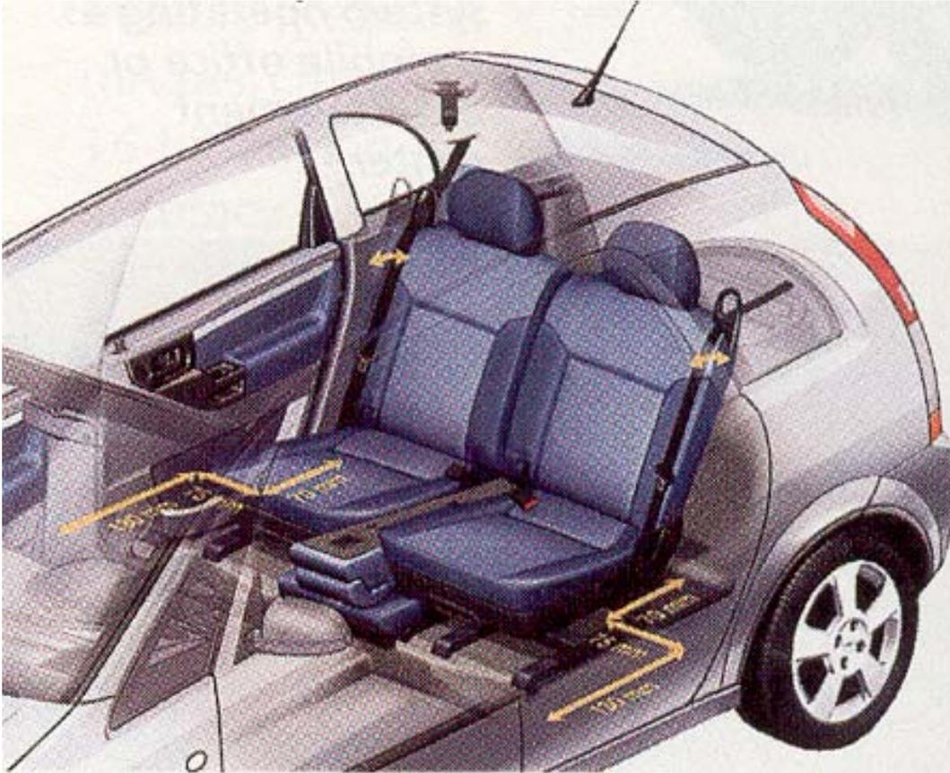
Figura 10-55 Meriva com sistema Flex Space. Divulgação da GM. Parte central do assento abaixa, as laterais se aproximam do centro da cabine e pode ser recuadas, para aumentar conforto. Isso é melhor para a segurança dos passageiros de trás.
