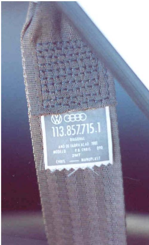
Figura 4-12 Etiqueta de identificação do cinto diagonal do Fusca 1981. Na penúltima linha, onde se lê 2MT, significa dois metros de comprimento.
