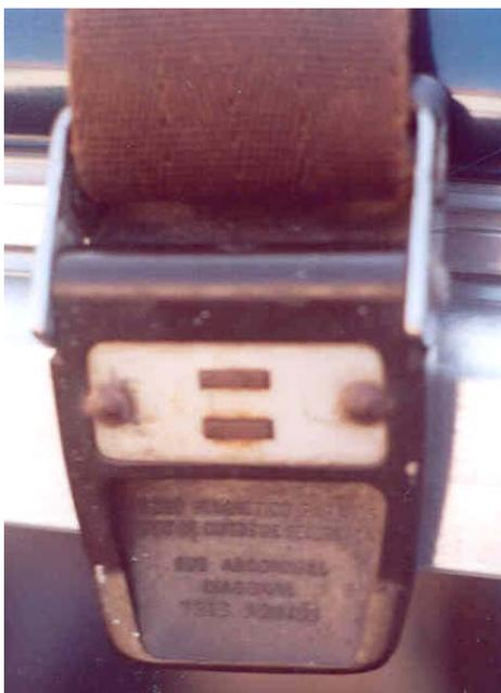
Figura 4-9 Parte de trás da fivela/alavanca do fecho tipo magnético, subabdominal, diagonal de três pontos em um carro dos anos 70.
