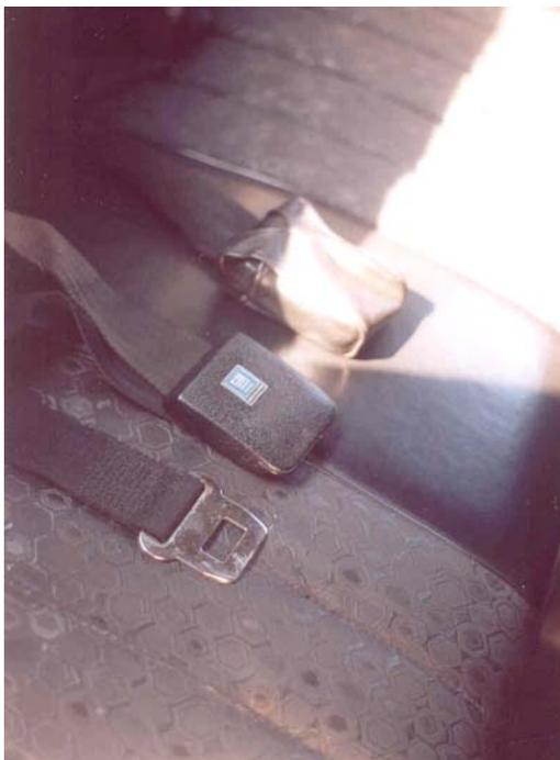
Figura 4-5 Fecho aberto tipo alavanca, com lingüeta na parte sem regulagem (baixo), fivela na parte regulável do cinto (meio) e bolsinha para guardar o terceiro cinto (alto) dianteiro subabdominal de 2 pontos de um Opala 1969.
