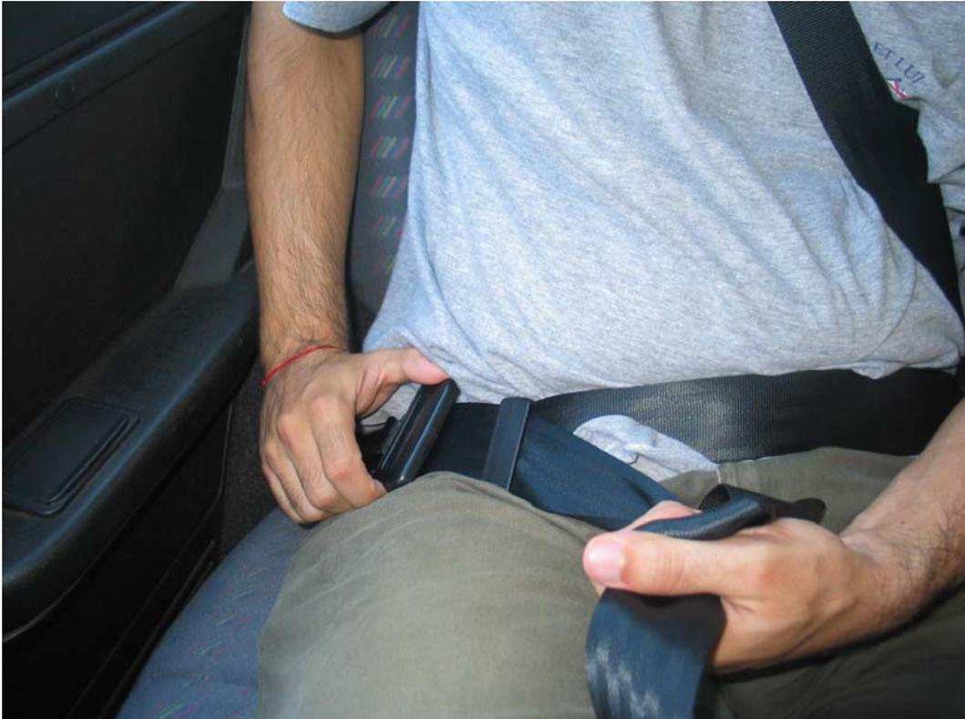
Figura 5-58 Cinto de 3 pontos fixo(sem retrator) original do Mille, do ano 1998 ao 2005.
