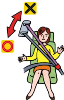
Figura 4-28 Ilustração de uma mulher pequena com duas posições da ancoragem do ombro: a incorreta (x), que passa pelo pescoço e a correta (o), que passa pelo ombro.
