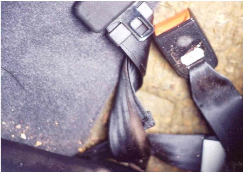
Figura 4-8 Fecho aberto tipo ‘push-button’ e da presença comum de impurezas no assento traseiro.
