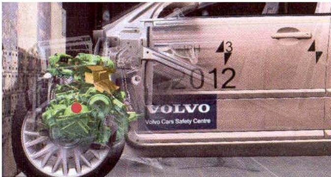
Figura 4-63 A simulação do teste de impacto frontal no computador mostra o grande enrugamento da dianteira favorecido pelo tamanho reduzido do motor. Divulgação da Volvo em 2004.
