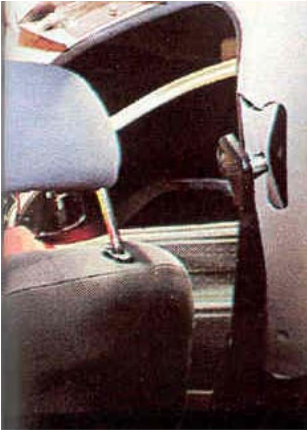
Figura 2-10 Dano causado na fixação do cinto na coluna 'B' do Corsa, resultado da força exercida pelo cinto para retenção de um manequim de 75Kg em um impacto a 30mph ou 48,3Km/h contra uma barreira rígida. Quatro Rodas, n. 484, nov. 2000, p. 89.
