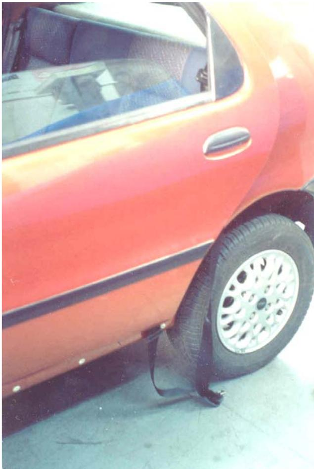
Figura 5-85 Palio 4 portas, ano 1996, com cinto traseiro fixo de 3 pontos caído fora do veículo, junto ao chão.
