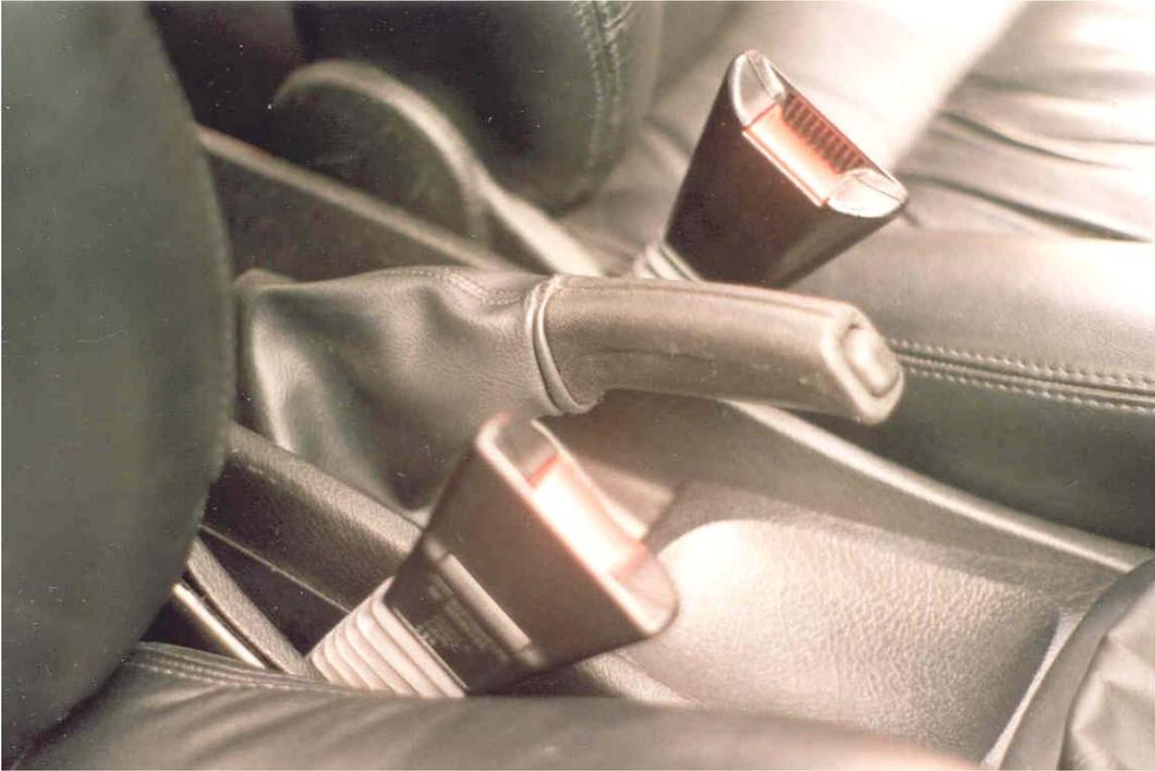
Figura 4-42 Fivelas dianteiras equipadas com pré-tensionadores em um Vectra 1999.
