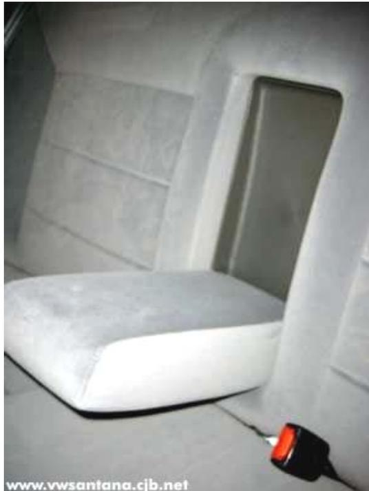
Figura 8-11 Fivela semi-rígida do Santana feito na China no ano 2004. Notar espaço entre assento e encosto por onde as fivelas moles costumam cair.
