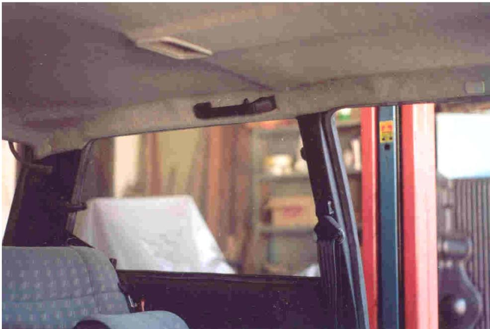
Figura 10-16 Detalhe da alça lateral de teto no lado esquerdo, antes da remoção.
