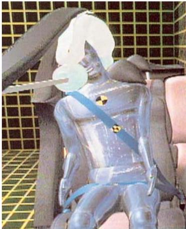
Figura 4-51 Ilustração do funcionamento do 'Window-bag' em Auto-CAD. Revista Autodata-Guia 2020.
