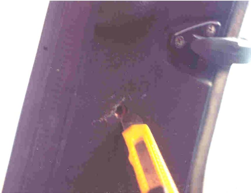
Figura 10-6 Com a capinha da ancoragem da coluna 'C' removida, foi necessário abrir um pouco mais o revestimento interno para rosquear o respectivo parafuso.
