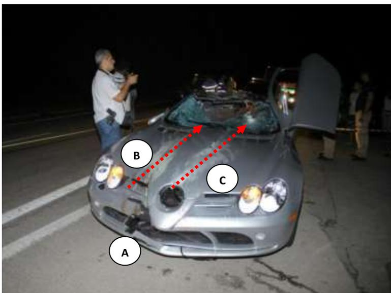
Alguns danos verificados no frontal do Mercedes mostram seu posicionamento quando do embate, ou seja, o dano no seu pára-choque (A) pode ter ocorrido pelo contato com a região dos pedais. As marcas longitudinais (B e C) no seu capô mostram um arraste com direcionamento conforme seta vermelha ocasionado pelo quadro da bicicleta.
