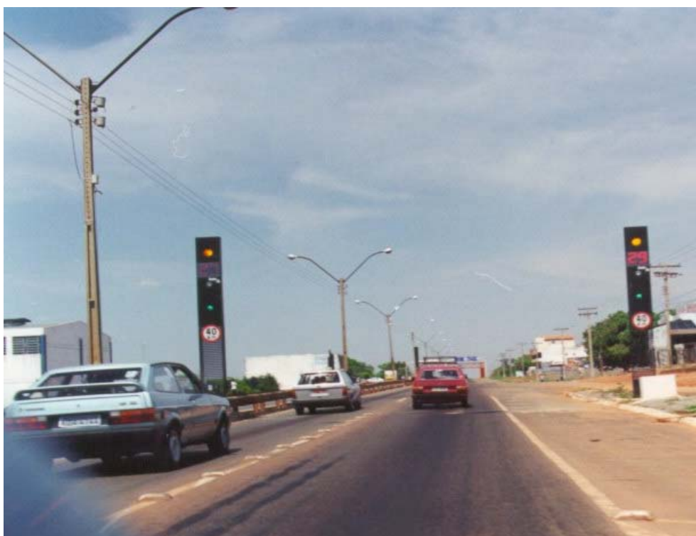
Figura 1 – Lombada eletrônica tipo monolito, implantada na rodovia GO-060.
