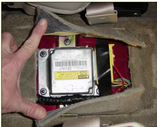
**Foto 3** Dispositivo EDR instalado entre os assentos (NextAutos, 2006)
